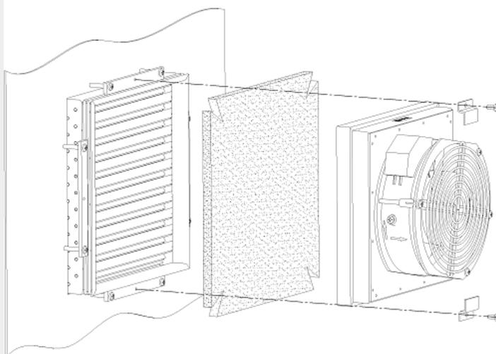
Фильтрующий материал предназначен для ВТШ-70 и ФТШ-70, класс фильтрующего материала G4, **2 шт** в комплекте.
