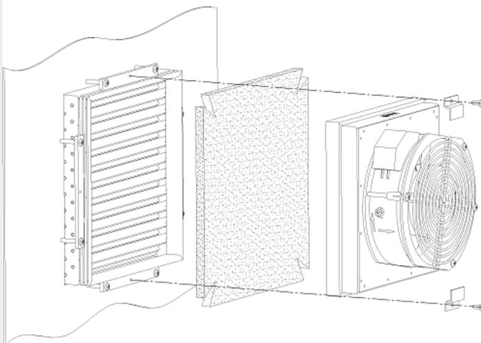
Фильтрующий материал предназначен для ВТШ-125 и ФТШ-125, класс фильтрующего материала G4, 2 шт в комплекте.
