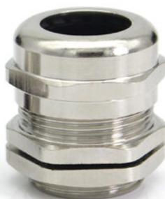
Кабельные вводы предназначены для герметичного ввода-вывода кабелей и проводов в термошкафах, обеспечивают защиту от попадания пыли, влаги и других внешних воздействий окружающей среды в месте ввода кабеля. Кабельные вводы сохраняют степень защиты IP67.
