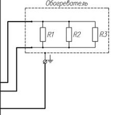
Болт заземления (БЗ)
