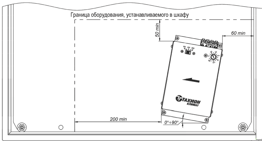
Рис.2 Пример установки на монтажной панели шкафа
